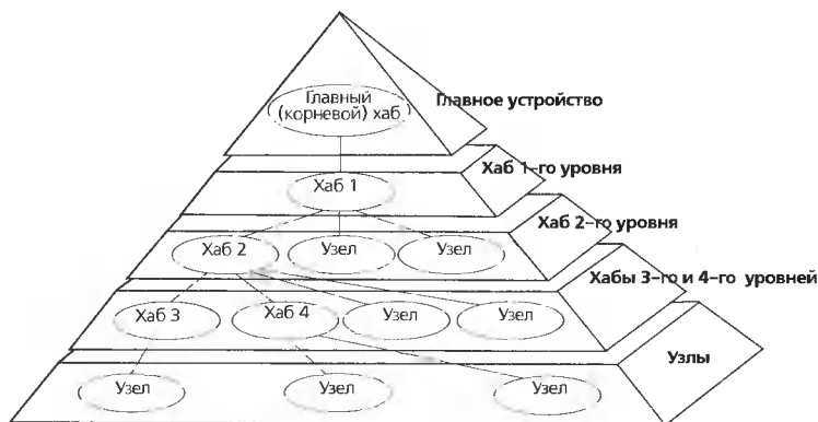
Рисунок 10.1 Топология шины USB
