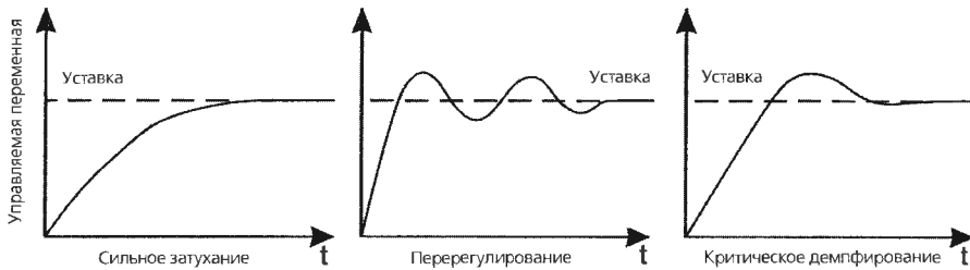
Рисунок 11.4 Влияние демпфирования на отклик замкнутой системы на ступенчатое воздействие
